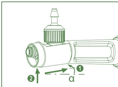
Insérer la douille noire avec un léger angle ① et enfoncer la jusqu'à la butée ②.
