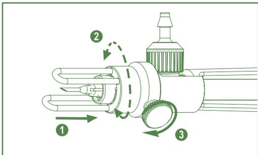
Insérer le FishGuide™ jusqu'à la butée ①, régler la position ②, serrer gentiment l'écrou ③.
